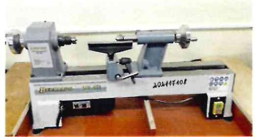
78. Tekinimo staklių griebtuve neturi būti išsikišusių dalių, galvučių, varžtų ir pan.
